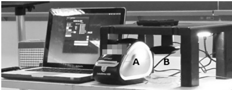
Figura 04. Protótipo de urna de 3o. geração desenvolvido, com destaque para (A) impressora de cédula de votação e (B) webcam de alta-resolução para conferência do código de barras padrão QR impresso na cédula de votação.
