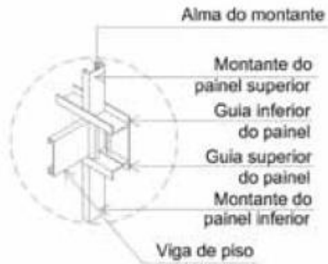
Figura Erro! Apenas o documento principal. - Painel típico em Light Steel Frame
