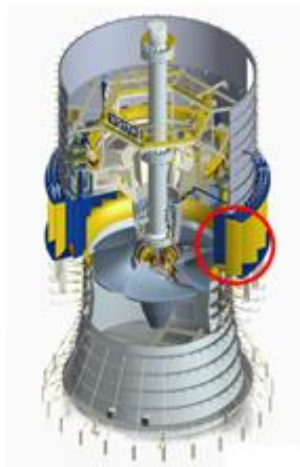
FIGURA 1 – Turbina Kaplan com a indicação, no círculo vermelho, das palhetas diretoras. Fonte: Adaptado de Voith (2015b).
