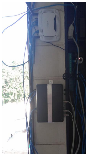
Figura 2- Caixa (preta) com os circuitos eletrônicos conectada aos sensores e fontes de alimentação, além do roteador para que tenha acesso à internet.
